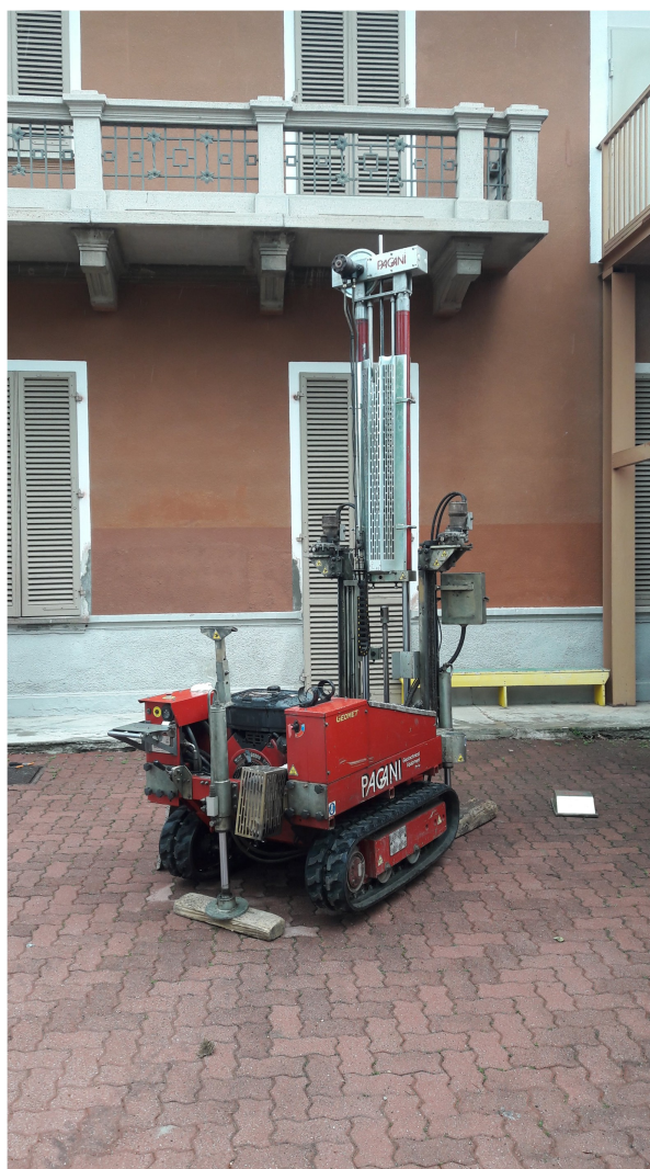
Fig 3: l'immagine riprende il penetrometro nel punto in cui è stata realizzata la prova P1.
